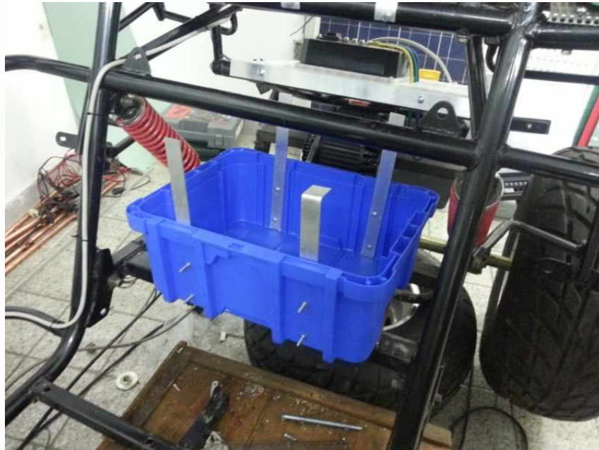
Slika 18: Kutija za smještaj akumulatora
