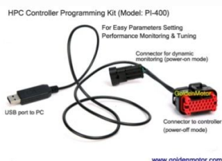
Slika 24: Konektor za spajanje kontrolera i računala
