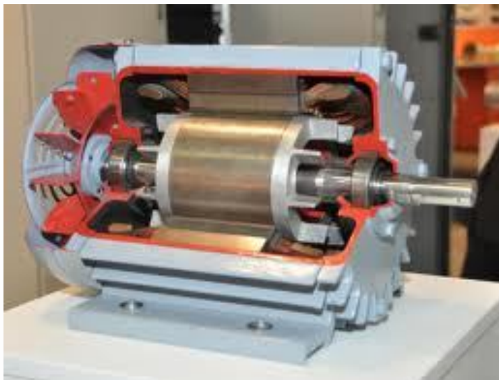
Slika 8: Presjek izmjeničnog asinkronog kaveznog motora
